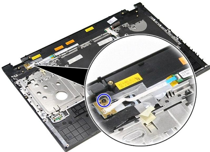
9. 打开将电源按钮电缆固定到电源按钮板上相应接口的线夹。
