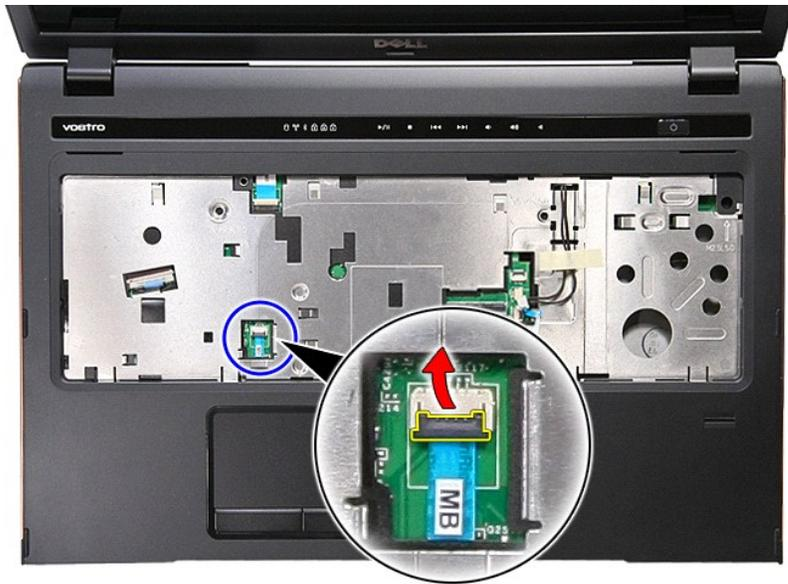
16. 在系统板上，断开触控板数据电缆与其接口的连接。
