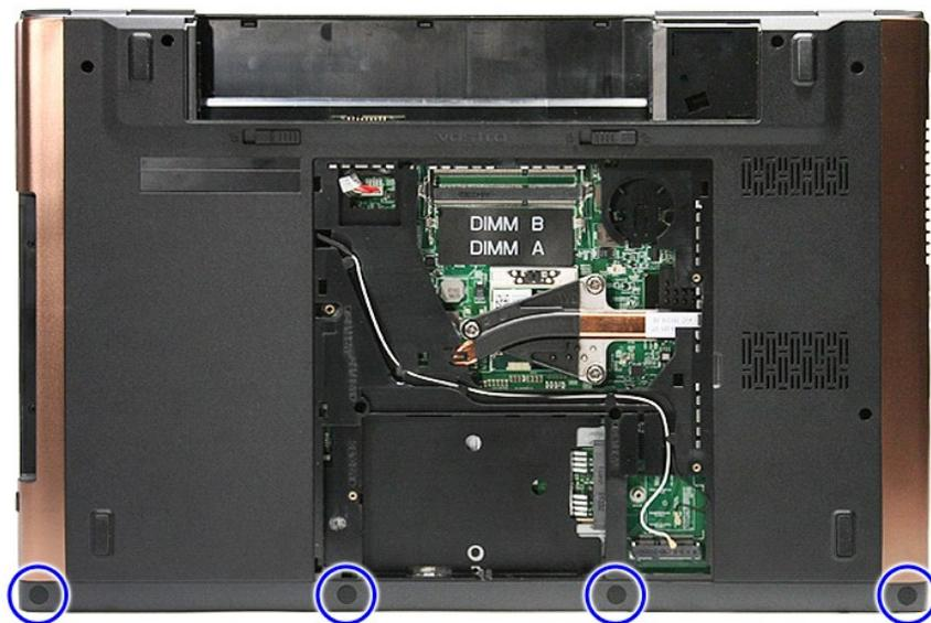
8. 拧下将掌垫固定到计算机底部的螺钉。
