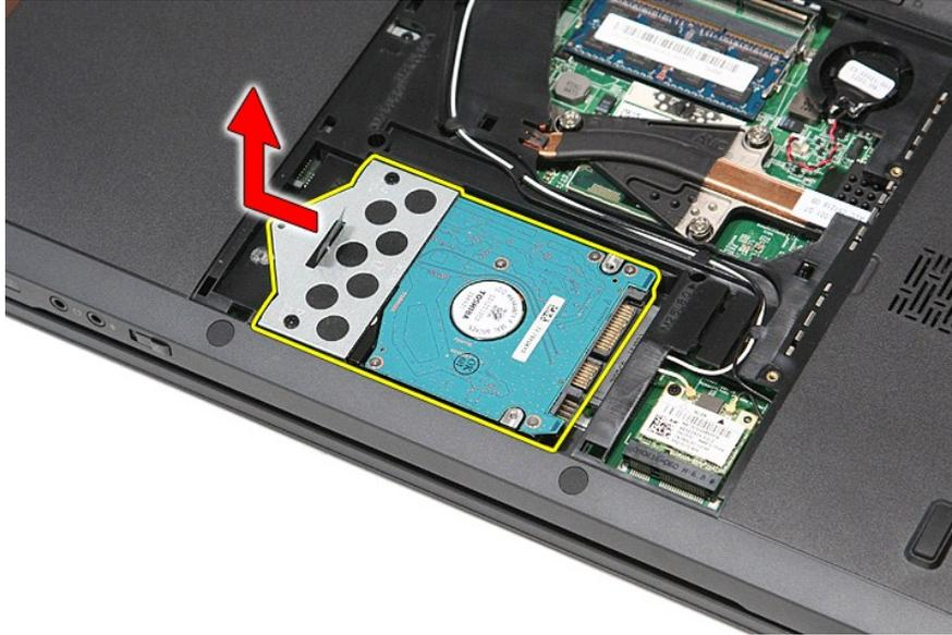
6. 拧下将硬盘托架固定到硬盘的螺钉。
