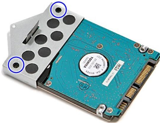
7. 向上提起硬盘托架，然后将其从硬盘部件中拆下。
