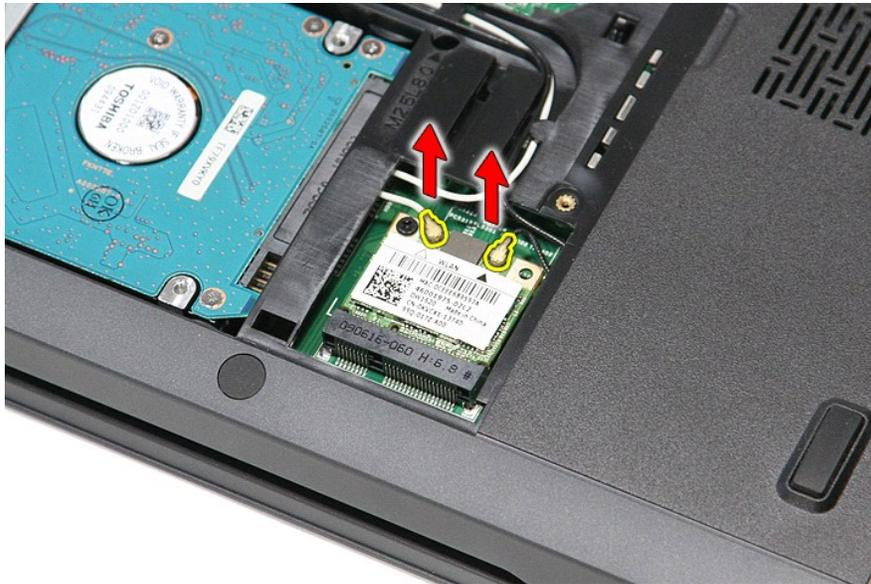
5. 拧下将 WLAN 卡固定到系统板的螺钉。
