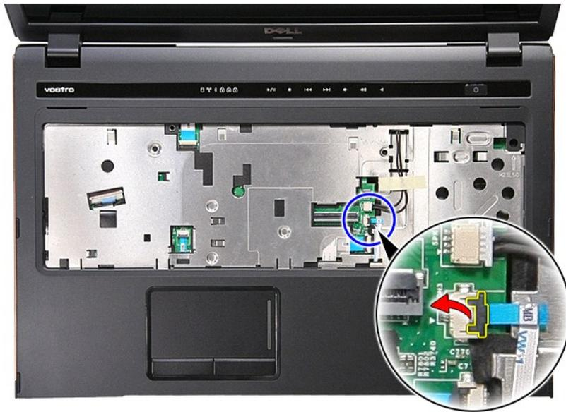
12. 在系统板上，断开指纹数据电缆与其在系统板上的接口的连接。
