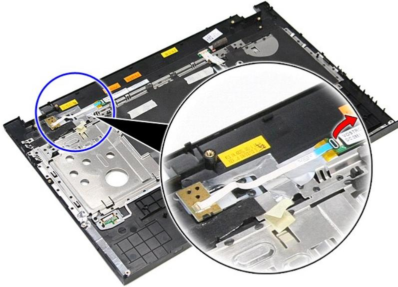
10. 断开电源按钮电缆与电源按钮板的连接。
