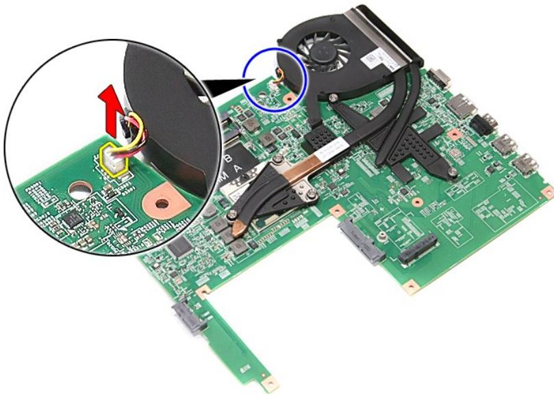
14. 松开将散热器和风扇部件固定到系统板的螺钉。
