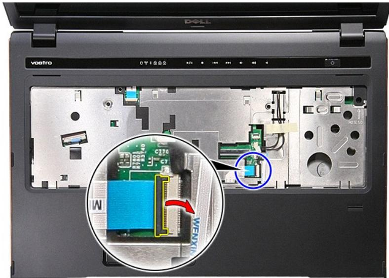
14. 在系统板上，断开音频电缆与其接口的连接。
