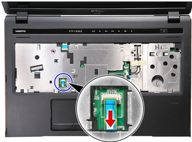
17. 打开将媒体按钮数据电缆固定到系统板上相应接口的线夹。
