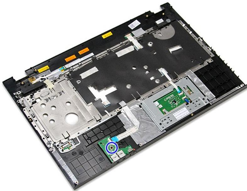
9. 在声卡上，打开将声卡电缆固定其接口的线夹。
