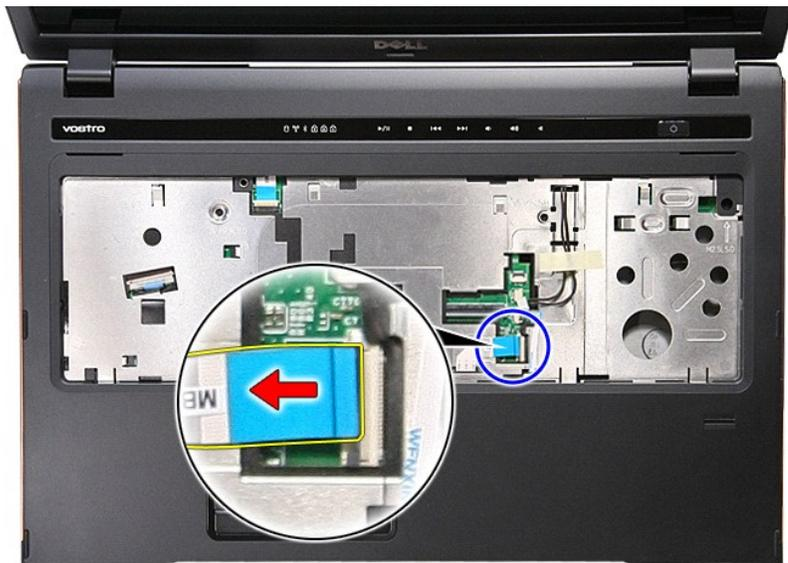
15. 在系统板上，打开将触控板数据电缆固定到其接口的线夹。
