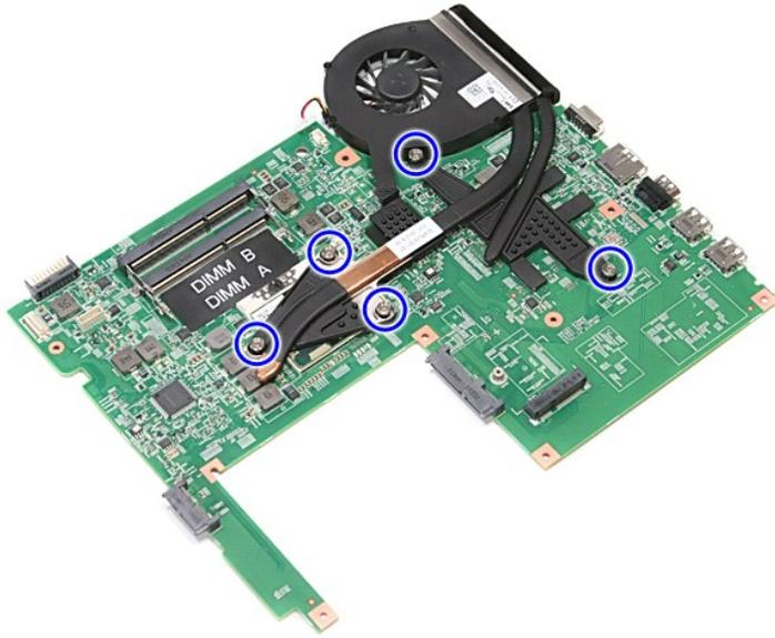
15. 向上提起散热器和风扇部件，然后将它们从系统板中拆除。
