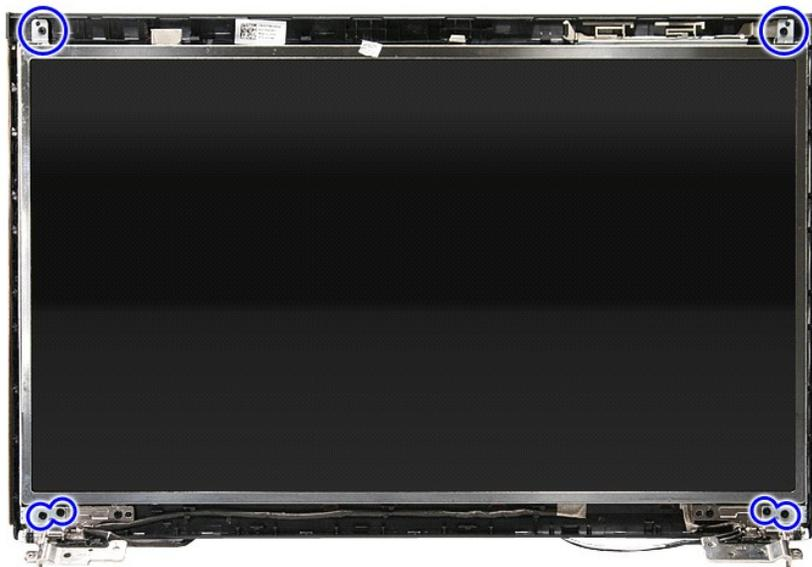
12. 将显示屏电缆从显示屏面板左边的铰链松开。
