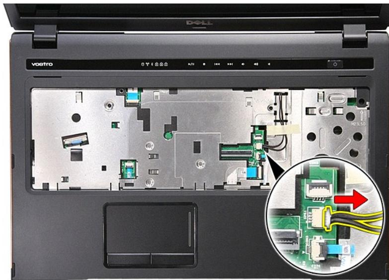
11. 在系统板上，打开将指纹数据电缆固定到其接口的线夹。
