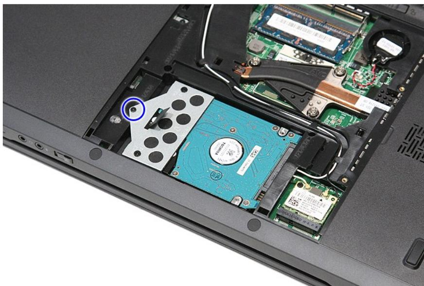
5. 将硬盘部件滑向计算机中心，然后向上提起，将其从计算机中取出。
