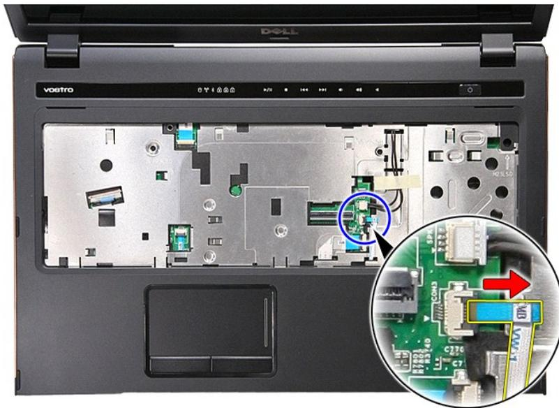
13. 在系统板上，打开将音频电缆固定到其接口的线夹。
