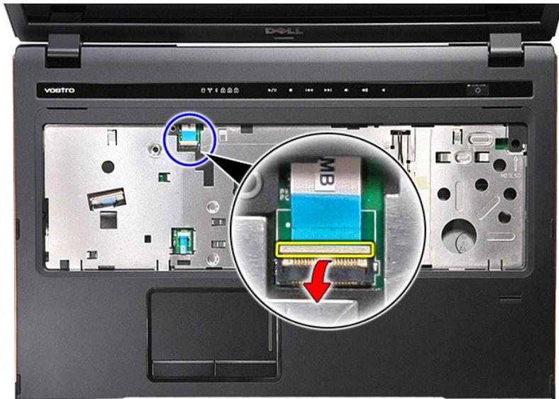
18. 断开媒体按钮数据电缆与系统板上相应接口的连接。
