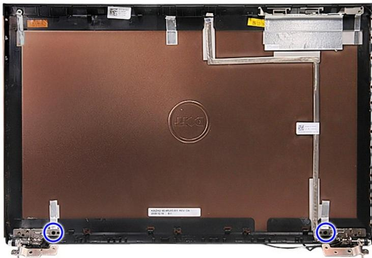
12. 将显示屏铰接部件从显示屏盖上拆下。
