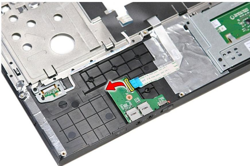
10. 在声卡上，断开声卡电缆与其接口的连接。
